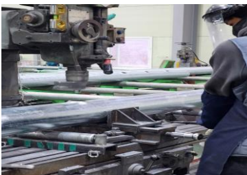
TEE 가공 후 밀링
