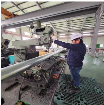
PIPE 홀 타공
