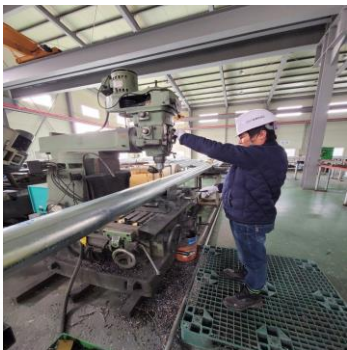
PIPE 홀 타공
