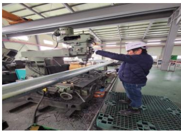
PIPE 홀 타공
